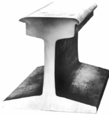
شکل الف-۸ - پخ شدن و ساییده شدن کلاهدک ریل
