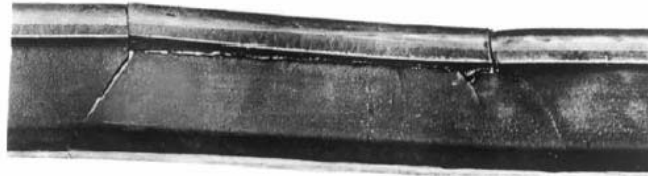
شکل الف-۶ - ترک افقی در محل انحنای اتصال جان به کلاهک
